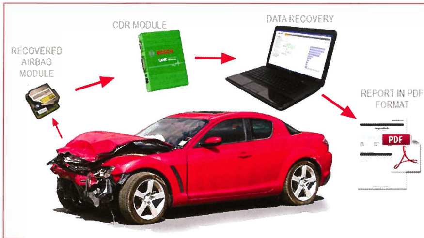
Abbildung 2: Der BOSCH Crash Data Retrieval Kit (CDR), siehe http://www.boschdiagnostics.com/cdr/sites/cdr/files/15-93_cdr_crash_data_retrieval.pdf
