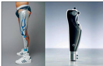
Abb. 7: Mikroprozessorgesteuertes Kniegelenk 2. Generation (Genium)
